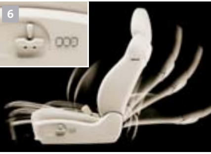
Siège conducteur à réglage électrique dans 8 directions avec deux positions de conduite mémorisables*3
