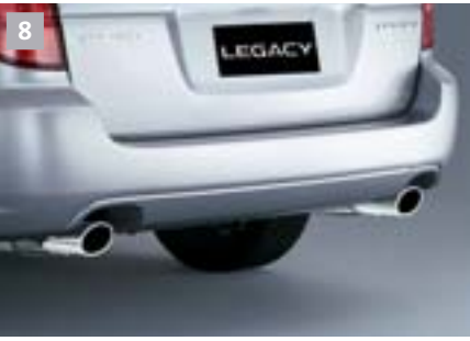
Sortie d'échappement double
