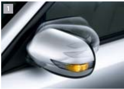
Rétroviseurs électriques rabattables avec clignotants à LED intégrés
