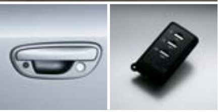
Système d'entrée sans clé avec démarrage par bouton-poussoir (en option)
