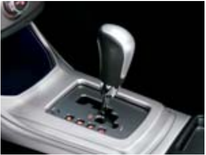
Boîte automatique à 4 rapports à commande électronique (SPORTSHIFT*2 BVA 4)
