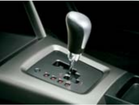
Transmission automatique à commande électronique à 4 rapports (SPORTSHIFT* BVA 4)
