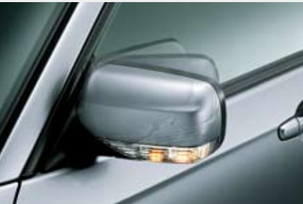
Rétroviseurs électriques rabattables avec clignotant à LED intégré
