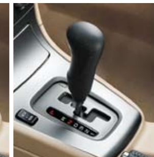
Transmission automatique à commande électronique à 4 rapports (BVA 4)
