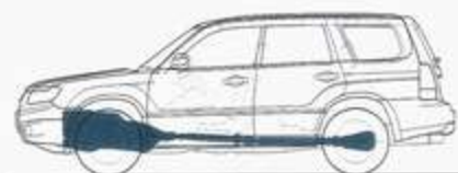
図理型的な運動性能を生む低重心(イメージ)
