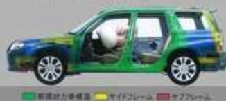
サブフレーム付新環状力骨構造ボディ ※図例のため色・形状は異なります。
