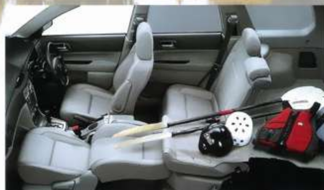
フラットスペース／フラットカーゴ／助手席のバックレストを後方に倒せば、さらに優れた積載能力を発揮。
