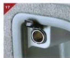
カーゴソケット (DC12V/120W) アウトドアでの電源として便利なソケットです。
