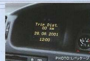
インフォメーションディスプレイ オーディオ情報、日付、時刻、路面状況を知る目安となる外気温度を表示。Lパッケージにはさらに平均燃費、平均速度、走行距離、車両コンディションなどを表示するマルチシステムを採用しています。
