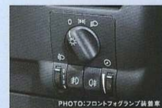
ライト集中コントロール ヘッドライトの点・消灯や光軸調整、イルミネーションコントロール、フォグランプやフロントルームランプの点・消灯などが集中して行えます。 ※ヘッドライト点・消灯用のダイヤルを手前へ引くと点灯
