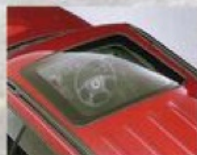
電動インナーサイド式 大型ガラスサンルーフ (UVカットガラス) キャビンに開放感をもたらすサンルーフ。 C/20を除く全車にメーカー装着オプション。
