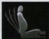
運転席8ウェイパワーシート スライド、リクライニング、チルト、リフターの 各調整が簡単なスイッチ操作で行えます。 T/25に標準装備。
