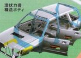
環状力骨構造ボディ このストリートなフレーム構造が、高い衝撃吸収能力を備えています。
