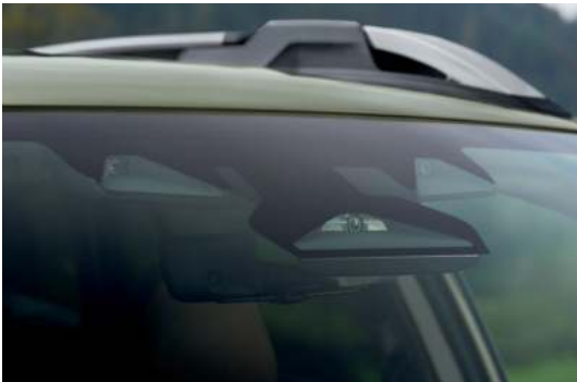
Technologie d'aide à la conduite EyeSight® 6 livrée de série avec monocaméra grand angle
