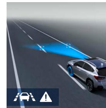
**Spurhalte- und Spurwechselassistent**
