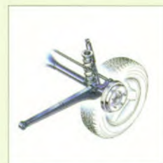
Op drie punten bevestigde achterwielophanging met starre as en Schroefveren.
