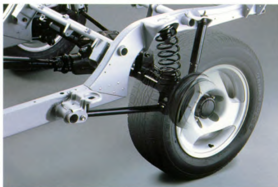
Multi-link schroefveer met starre as achter
