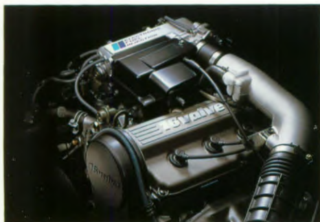
G16B 4-cilinder SOHC 1,590 cm 3 met elektro- nische multi-point injectie
