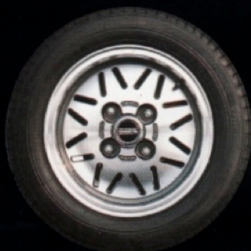
ALU-FELGE : Für die sportliche Note. Poliertes Aluminium, klarlackgeschützt. Felgenreöße: 5J x 13. (zugelassene Reifengrößen 155/70 HR13, 165/65 HR13 und 175/60 HR13 und zusätzlich für die GTi-Version: 185/60 HR 13.
