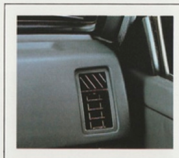
Effectieve zijruitontwaseming door roosters in het dashboard
