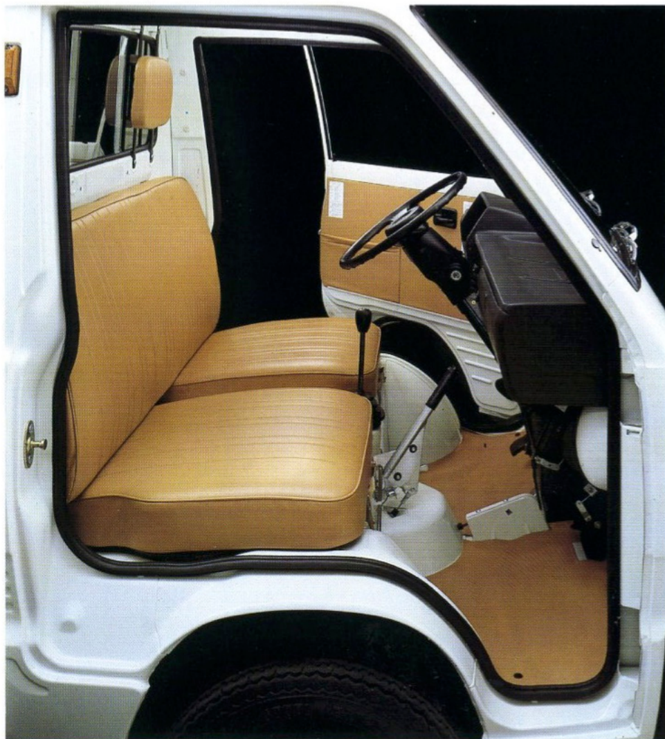
Door de bestuursstoel weg te klappen, bereikt U gemakkelijk de motorruimte.
