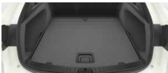
Piano di carico double face (lato rivestimento morbido)
