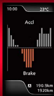
Muestra datos de aceleración y frenada
