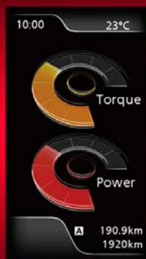
Muestra información sobre potencia y par en tiempo real
