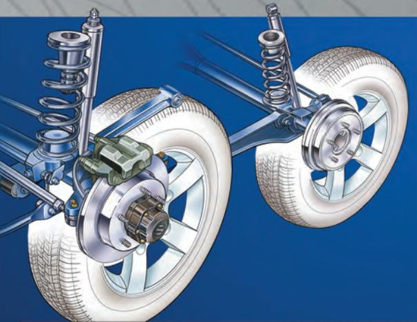
Suspensão Trilink, eixo rígido e molas helicoidais com amortecedores independentes
