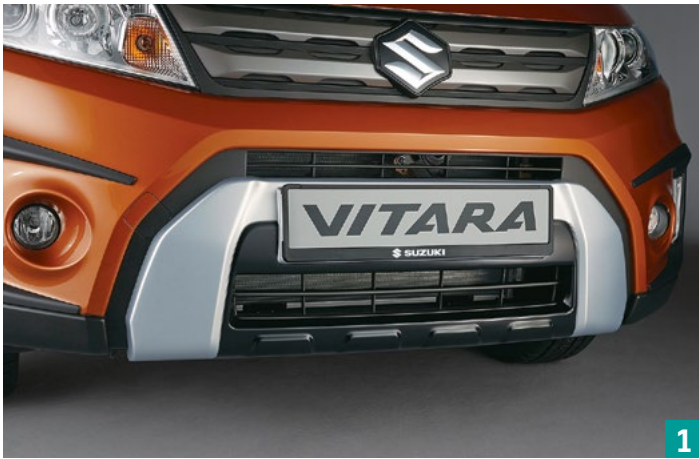
1 | Unterfahrschutz vorne lackiert in silber/schwarz, ersetzt Originalteil Art.-Nr. 990E0-54P44-000
