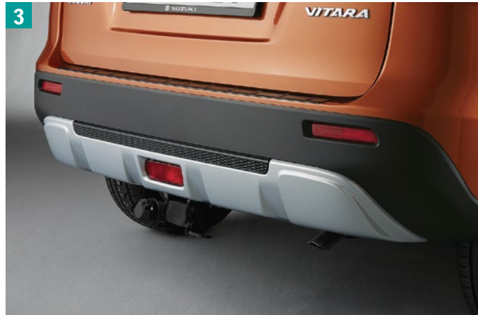
3 | Unterfahrschutz hinten lackiert in silber/schwarz, ersetzt Originalteil Art.-Nr. 990E0-54P47-000
