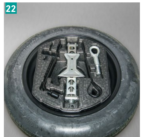
22 | Notrad-Kit Das Notrad-Kit passt perfekt in die serienmäßige Reserveradmul- de. Das Bordwerkzeug kann ver- rutschsicher in der enthaltenen Box in der Felge verstaut werden. (ohne Werkzeug)
