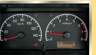
Speedometer dengan indikator bensin, tripmeter & odometer digital.
