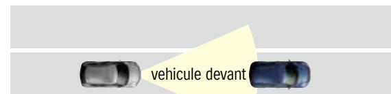
Si le véhicule qui précède roule moins vite que la vitesse sélectionnée, le système ralentit pour maintenir la distance de sécurité.
