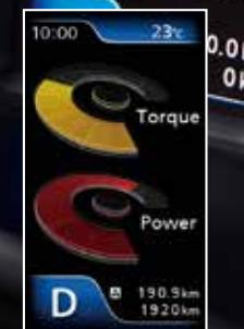
Affichage en temps réel de la puissance et du couple délivrés par le moteur
