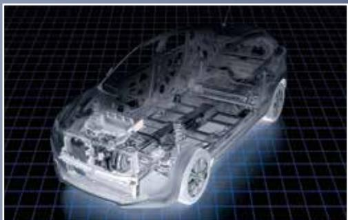
La plate-forme a été conçue pour optimiser la structure de la coque. Avec 30 kilos en moins sur la balance par rapport à la précédente plateforme, cet allègement permet d'améliorer le rendement global de la voiture. Cette plate-forme a donc été développée à l'avantage du comportement routier, du rendement énergétique, de la sécurité et du niveau vibratoire et acoustique. Cet important allègement a été atteint en repensant complètement sa conception et non pas en modifiant la base existante.
