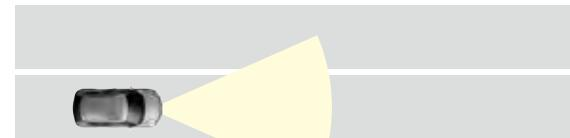
Si la distance avec le véhicule qui précède la Suzuki Baleno est suffisante, le système maintient la vitesse choisie par le conducteur.
