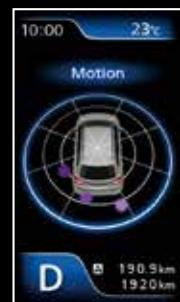
Affichage en temps réel des forces d'accélération appliquées au véhicule
