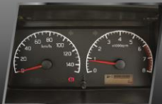
Speedometer dengan indikator bensin, tripmeter & odometer digital.
