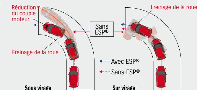
**ESP® de série.** Système de contrôle de stabilité, permettant de détecter un écart et de remettre le véhicule en ligne en cas de modification de la trajectoire.
