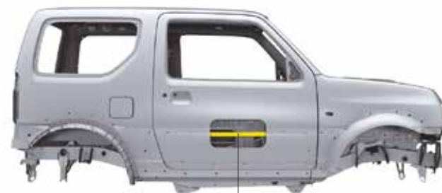
Barre laterali anti-intrusione incorporate nelle portiere
