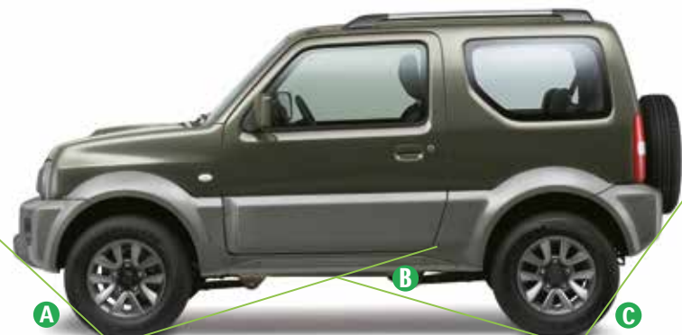
A 34° angolo di attacco (settaggio predefinito, veicolo senza carico) B 31° angolo di dosso C 46° angolo di uscita
