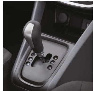
Automatisiertes Schaltgetriebe (AGS) 2
