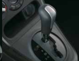
Automatische viertrapstransmissie (verkrijgbaar bij 1.2 liter).
