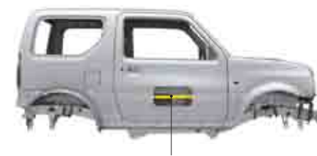
Barre laterali anti-intrusione incorporate nelle portiere
