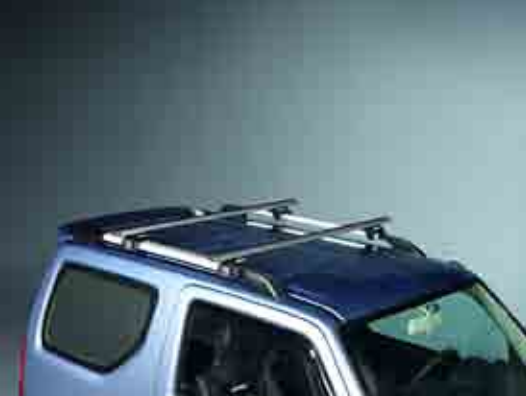
Barre portatutto in alluminio (portata massima 75 kg)
