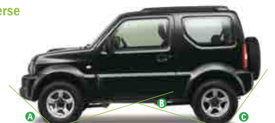
A 34° angolo di attacco (settaggio predefinito, veicolo senza carico)
