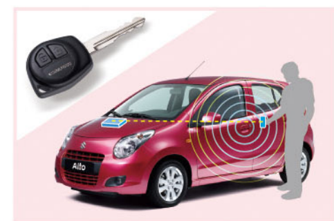
Immobilizer晶片感應防盜系統 + 遙控鎖 SUZUKI配備守護愛車的晶片感應防盜系統，內建引擎發信裝置，密碼不符時引擎不會啟動，讓竊賊無法利用複製鑰匙開走愛車；另配有遙控鎖，上下車時僅須輕壓遙控鎖按鈕，即可輕鬆啟閉車門。
