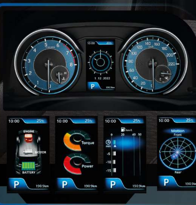
มาตรวัดพร้อมจอ LCD แสดงข้อมูลการขับขี่ Driving G-force และอัตราสิ้นเปลืองน้ำมันเชื้อเพลิง
