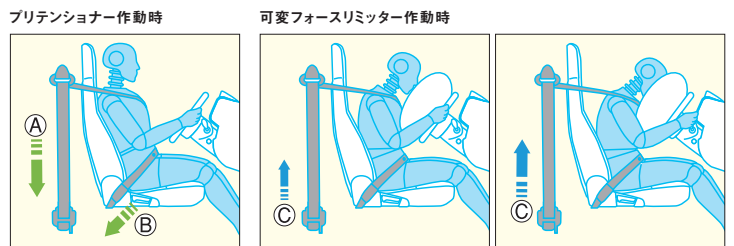
①リトラクタプリテンショナー(運転席、助手席) ②ラップアウタープリテンショナー(運転席) ③可変フォースリミッター(運転席、助手席)
