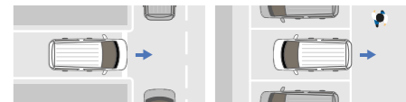
前方左右確認サポート機能 後方左右確認サポート機能
