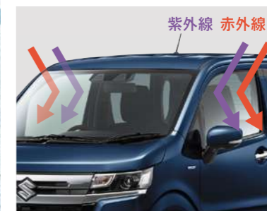
プレミアムUV&IRカットガラス (フロントドア) (HYBRID ZXアップグレードパッケージ装着車、HYBRID ZT) ※1
