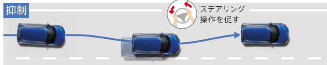
●ドライバーの緊急操舵時は、ドライバーの操舵を妨げません。●ウインカーが出ている間は、車線変更の意図があると判断し、車線逸脱抑制機能および車線逸脱警報機能を一旦停止します。
