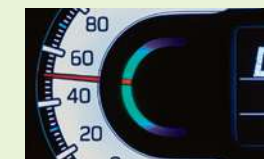
通常の運転状態
