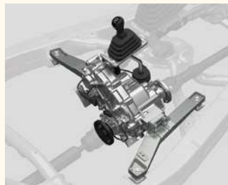
機械式副変速機
