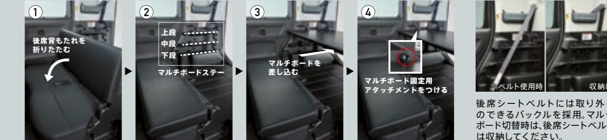
●事故の際、マルチボードや荷物が飛び出しえる恐れがあります。次の内容を守ってください。●走行時はマルチボード固定用アタッチメントを必ず装着してください。●上段にマルチボードを設置して走行する際は、後席シートベルトには取り外しのできるバックルを採用。マルチボード切替時は、後席シートベルトは収納してください。
