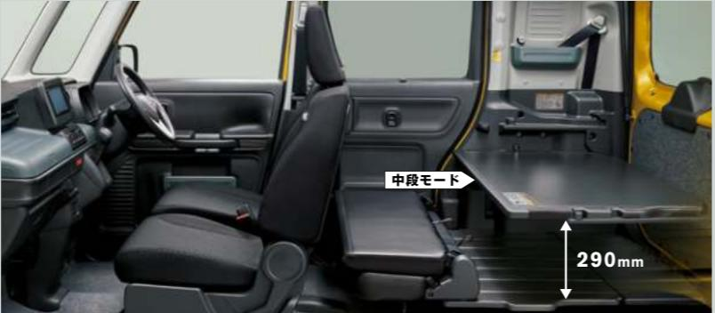
マルチボード耐荷重:最大12kg(中段モード)
