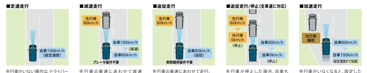
●追従走行は、約40km/h未満でも動作し、停止まで継続します。●追従走行中の先行車が停止すると自車も停止し、その後約2秒でブレーキは解除されます。停止を続ける場合は、必ずブレーキペダルを踏んでください。
