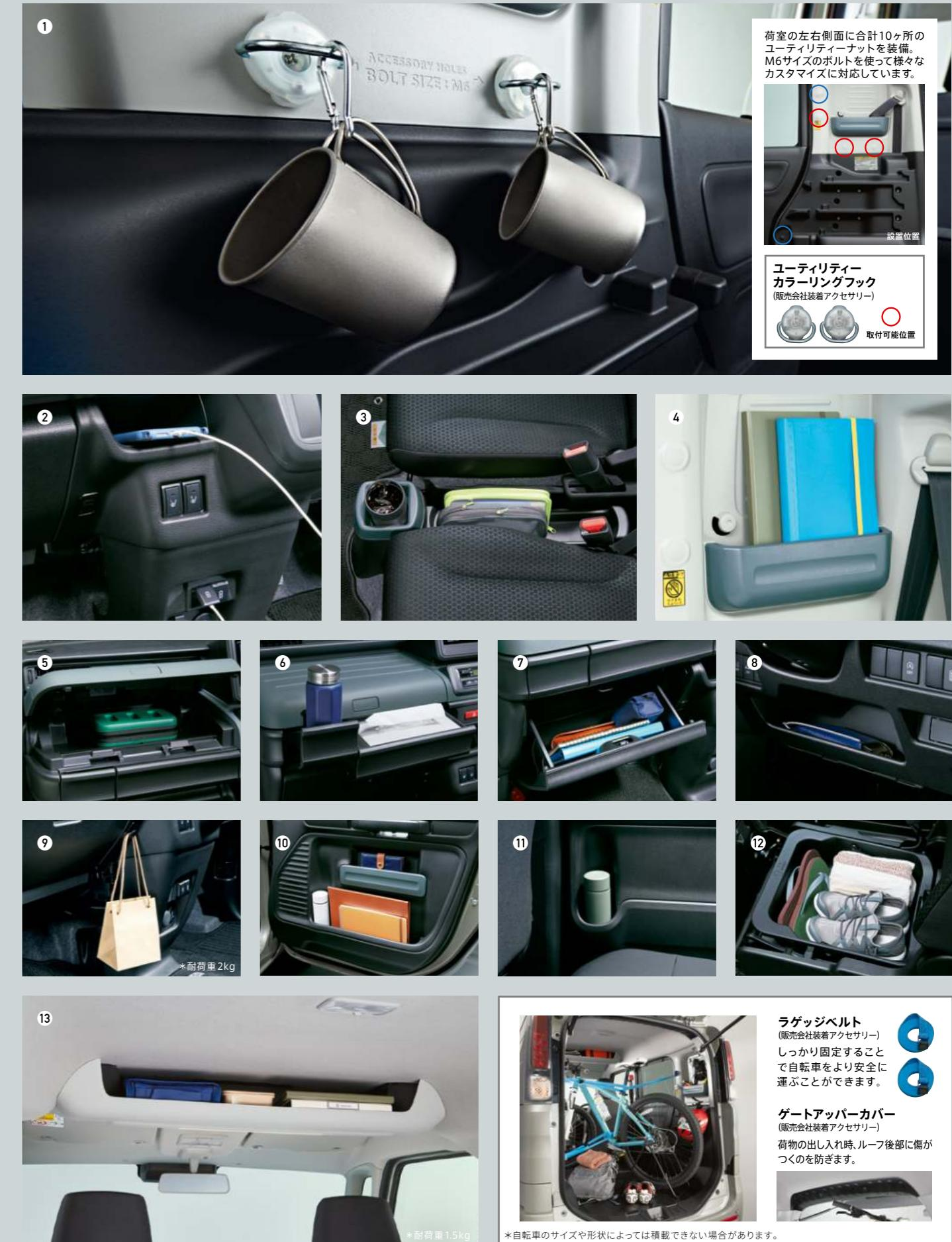
荷室の左右側面に合計10ヶ所のユーティリティーナットを装備。M6サイズのボルトを使って様々なカスタマイズに対応しています。
