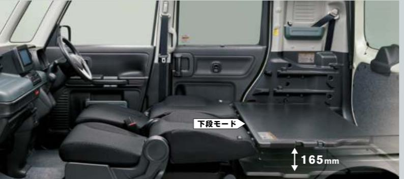
マルチボード耐荷重:最大18kg(下段モード)
