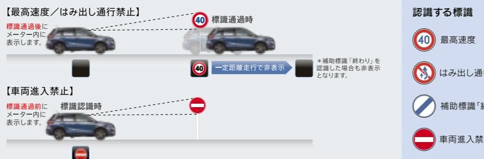
走行中に、単眼カメラが認識した“車両進入禁止”的標識を標識通過前にメーター表示でドライバーにお知らせします。
