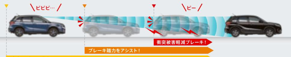
\*衝突被害軽減ブレーキ機能作動時は強いブレーキがかかりますので、走行前に全ての乗員が適切にシートベルトを着用していることをご確認ください。\*衝突被害軽減ブレーキ機能による車両停止後は、クリープ現象により前進しますので、必ずブレーキペダルを踏んでください。
