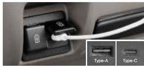
USB電源ソケット [Type-A/Type-C] (インパネ、2個) (PAを除く) *出力電流はType-Aは2.4A、Type-Cは3Aとなります。
