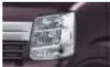
ディスチャージヘッドランプ [ロービーム、オートレベリング機構付]
