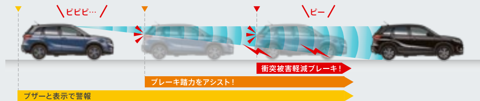
*衝突被害軽減ブレーキ機能作動時は強いブレーキがかかりますので、走行前に全ての乗員が適切にシートベルトを着用していることをご確認ください。*衝突被害軽減ブレーキ機能による車両停止後は、クリープ現象により前進しますので、必ずブレーキペダルを踏んでください。
