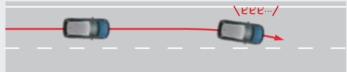
●車線逸脱抑制機能はドライバーがステアリング操作をしている間のみ作動します。●ドライバーの緊急操舵時は、ドライバーの操舵を妨げません。●ウインカーが出ている間は、車線変更の意図があると判断し、車線逸脱抑制機能を一旦停止します。
