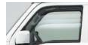
パワーウィンドー[ロック機構/ 運転席オート・挟み込み防止機構付] (JOINターボ、JOIN:フロント、リヤ) (PC、PAリミテッド:フロント)
