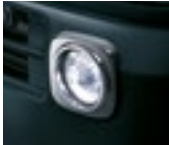
フロントマルチリフレクター ハロゲン Fogランプ
