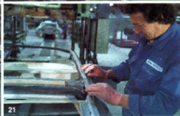
10 - 21 Verkleben mit Zweikomponentenklebern; ein Klebstrang wird aufgetragen (10); Montage des Unterbau/Stirnwand (11-12); Montage des Unterbodens (13); Vorbereitung und Montage der Seitenteile; Vorbereitung, Montage und Polymerisation des Dachhimmels; Endmontage und Kontrolle (14-21).
