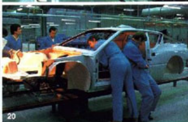
10 - 21 Verkleben mit Zweikomponentenklebern; ein Klebstrang wird aufgetragen (10); Montage des Unterbau/Stirnwand (11-12); Montage des Unterbodens (13); Vorbereitung und Montage der Seitenteile; Vorbereitung, Montage und Polymerisation des Dachhimmels; Endmontage und Kontrolle (14-21).
