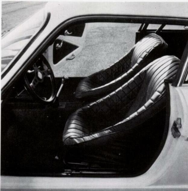
Auf Wunsch Schalensitze (für Wettbewerbsfahrzeuge). Das griffige Sportlenkrad liegt gut in der Hand. Es lässt immer freie Sicht auf die reichhaltige, sportlich ausgestattete Armaturentafel mit Tourenzähler, Kilometerzähler mit Tageskilometer, Kühlwasserthermometer, Lade-Kontrolle und Öldruckmanometer. Kurze, handliche Knüppelschaltung, direkt und schnell, vollsynchronisiertes 5-Gang-Getriebe. Wirksame, fein dosierbare Klimaanlage, die Sie genau auf Ihre Wunschttemperatur einstellen können.
