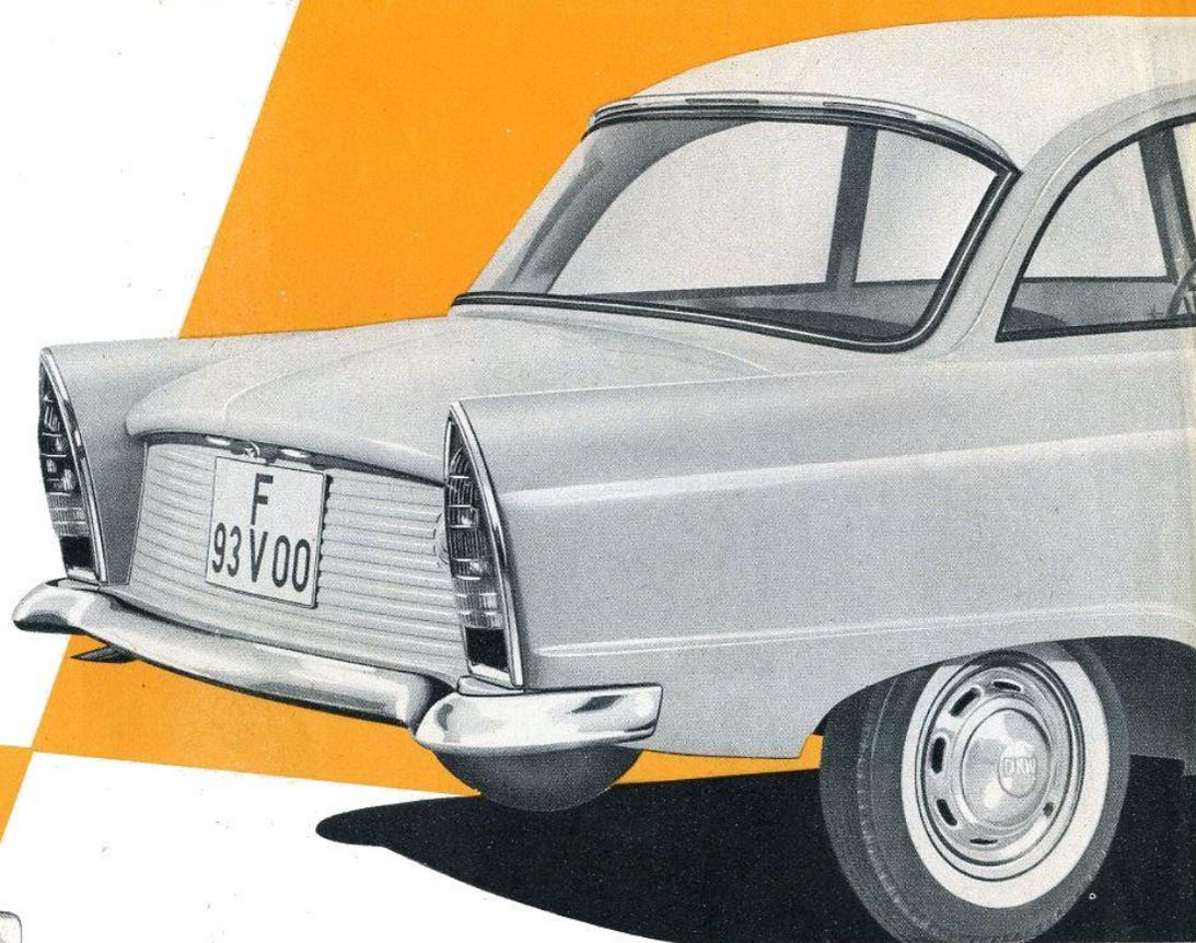
Als „echter“ DKW ein „echter“ Familienwagen. Ein wassergekühlter DKW-Zweizylinder-Zweitaktmotor, eine überzeugende Straßenlage durch Frontantrieb und Drehstabfederung, eine zeitlos elegante Linie mit vorbildlichen Sicht- und Sitzverhältnissen. Hubvolumen: 660 ccm. Leistg.: 30 PS b. 4200 U/min. Getriebe: Viergang sperrsynchrisiert. Gewicht: 610 kg. Höchst- und Dauergeschwindigkeit: 110 km/h.
