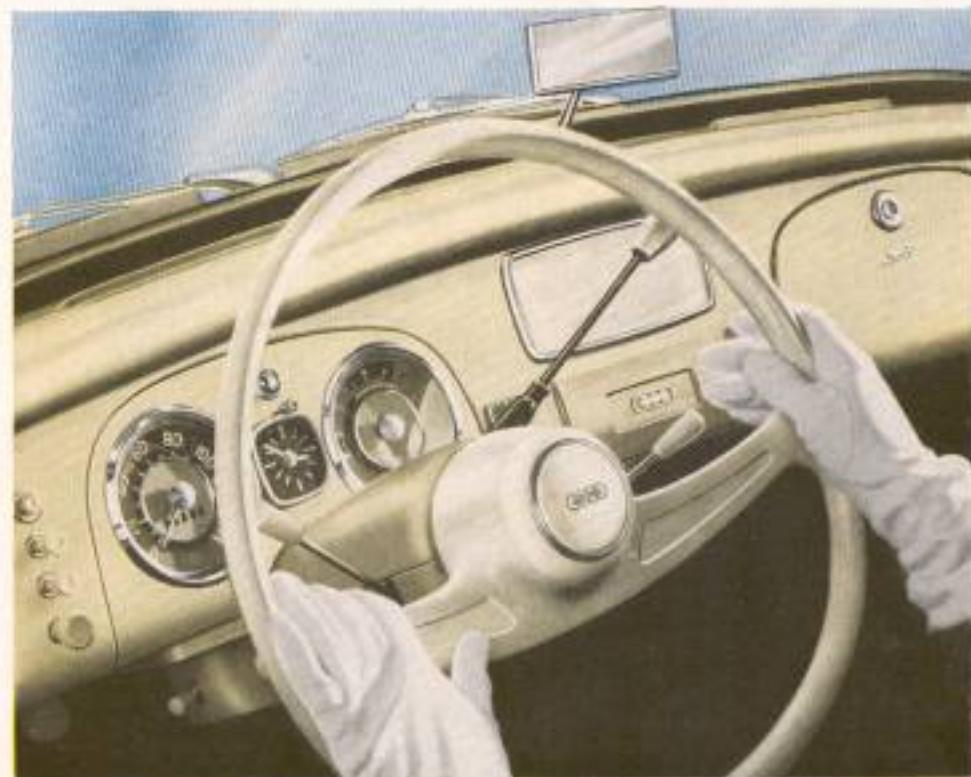
Das Bild zeigt das auf Sachlichkeit abgestellte, formschöne Armaturenbrett mit dem leicht ovalen Lenkrad. Alle Bedienungshebel sind griffnahe – rechts an der Steuer- säule die Hebel für die Schaltung und für die Blinkanlage, links der Hebel für Lichtschaltung mit der Lichthupe. Sämtliche Instrumente sind mit einem Blick zu erfassen. Eine Zeituhr und ein diebstahlsicheres Lenkschloß gehören zur serienmäßigen Ausstattung.
