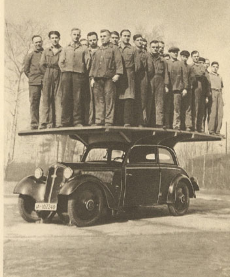
So fest ist die Karosserie des DKW-Front, daß sie die ungeheure Belastung von 32 erwachsenen Männern aushält, ohne daß die Türen klemmen oder die Scheiben springen. Ohne jegliche Veränderung oder Reparatur lief dieser Wagen nach dem Fotografieren wieder im regelmäßigen Dienst.
