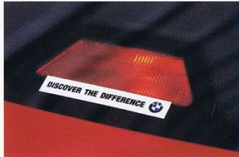
急ブレーキを踏んでも、ハイマウント・ ブレーキ・ライトが後続車に確実に 知らせ、背面への衝突の危険性を 減少させます。
