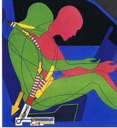
運転席・助手席シートベルトの効 果を最大限に発揮させる。ベルト キャッチ・デンシトナーを標準装備。
