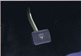
ドイツをはじめヨーロッパ中の 教習車に採用されている Veigel社製の補助ブレーキ
