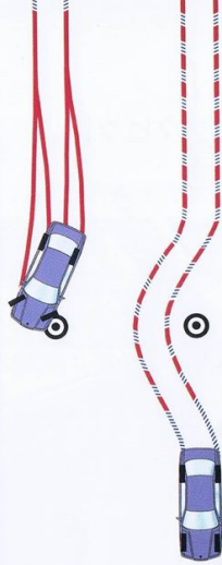
教習生のパニック・ブレーキにも、ABSを標準 装備した強力なブレーキが高い制動性を発揮。 *補助ブレーキでもABSの効果を得られます。
