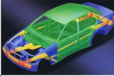
万の際突時でもクラッシュパ ンが衝撃を吸収し、強固な キャビンが乗員をしっかりと保護。
