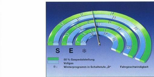
Mehr Komfort: Das auf Wunsch für die Sechszylinder erhältliche 5-Gang-EH-Automatic-Getriebe verfügt über drei Fahrprogramme: So schaltet z. B. das Winterprogramm früh und weich hoch, um ein gefühlvolles Fahren auf glattem Untergrund zu ermöglichen.
