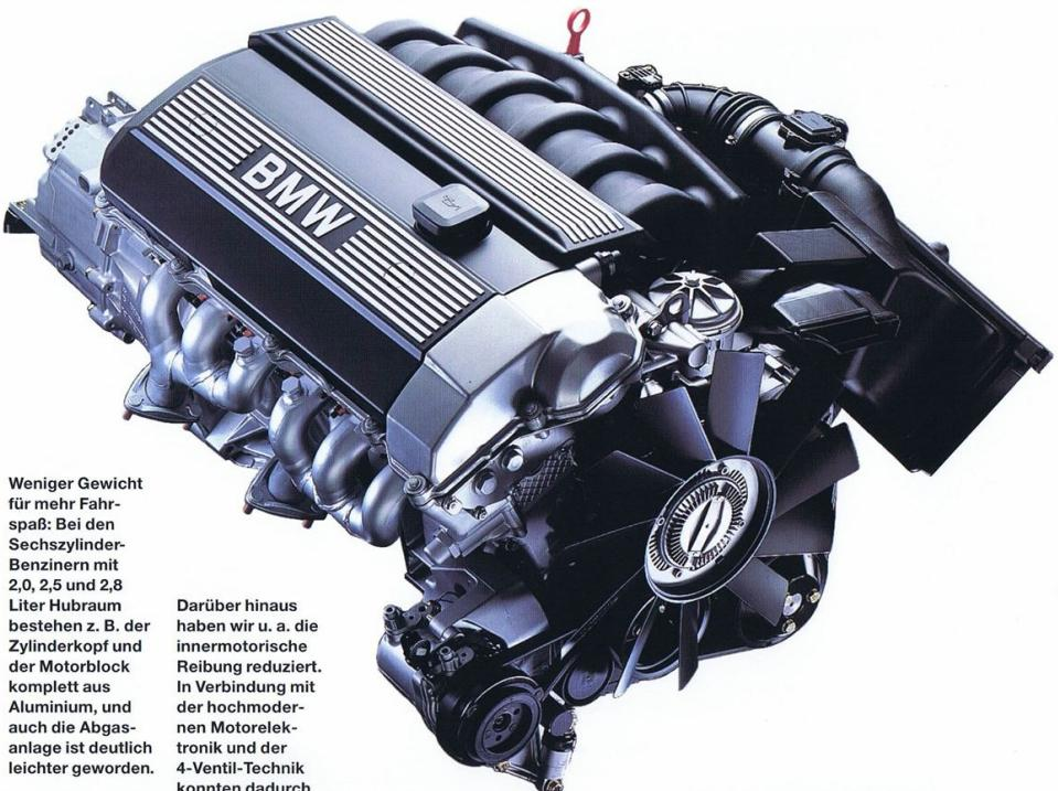
Weniger Gewicht für mehr Fahrspaß: Bei den Sechszylinder-Benzinern mit 2,0, 2,5 und 2,8 Liter Hubraum bestehen z. B. der Zylinderkopf und der Motorblock komplett aus Aluminium, und auch die Abgasanlage ist deutlich leichter geworden.
