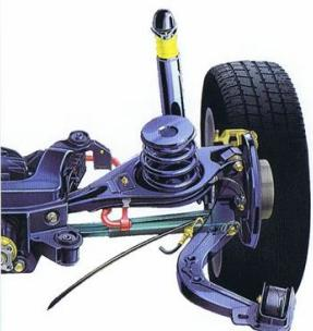
Die patentierte Zentrallenker-Hinterachse ist zusammen mit der Federbein-Vorderachse die Basis für exzellenten Fahrkomfort und begeisternde Fahrdynamik. Für uns bedeutet das vor allem die Voraussetzung für aktive Sicherheit auf BMW Niveau.
