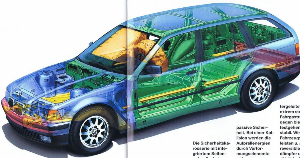
tergeleitet. Der extrem steife Fahrgastrraum hingegen bleibt weitestgehend formstabil. Wirksamen Fahrzeugschutz leisten u. a. die reversiblen Pralldämpfer und zusätzliche Verformungselemente.
