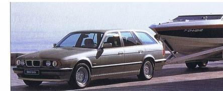
Der 5er touring beeindruckt nicht zuletzt auch durch seine hohe Zugkraft: Anhängelasten von bis zu 2175 kg sind möglich.
