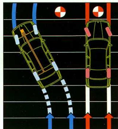
**Das Anti-Blockiersystem. Das BMW 4-Sensor-ABS bietet höchste Sicherheit beim Bremsen. Bei Vollbremsungen bleibt die Lenkfähigkeit Ihres Cabrios erhalten. (Bei allen Modellen Serie.)**
