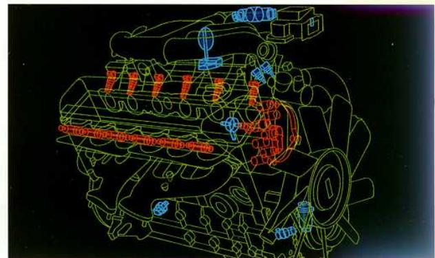
**Intelligentes Motormanagement.** Für höchste Laufkultur, optimale Wirtschaftlichkeit und exzellente Leistungsausbeute informiert sich die Digitale Motor Elektronik (DME) an diesen Schnittstellen über die Fahrumstände. Alle Daten werden in Sekundenbruchteilen gegengerechnet und in exakte Steuerungsimpulse umgesetzt.
